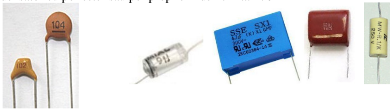
Figura 12: condensatoare: ceramice, stiroflex, poliester, polipropilenă
