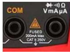
Fig. 9b borne separate de măsură Permit orice fel de măsurare
