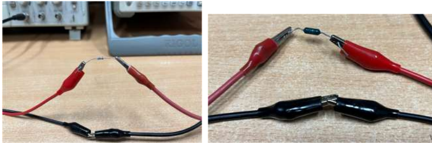
Figura 16: Conectarea rezistenței adiționale
