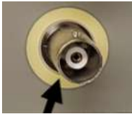
Fig. 9a conector BNC Permite doar măsurarea față de masă
